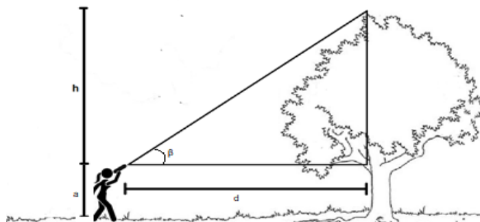
Figura 7 - Utilização do teodolito na trigonometria. Fonte: O autor (2019)
