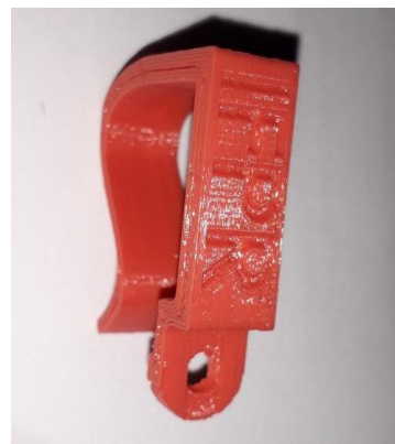
Figura 5 - Protótipo impresso da 1ª versão do microscópio portátil. Fonte: Os autores (2019)
