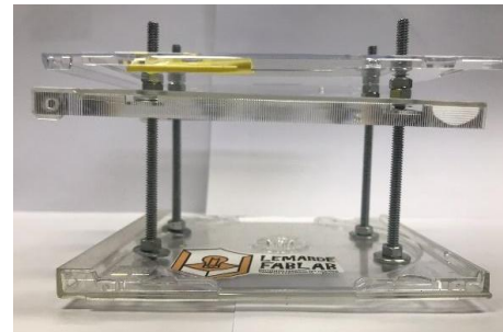
Figura 2 - Estrutura do Microscópio de mesa. Fonte: Os autores (2019)
