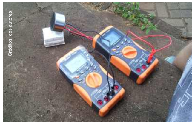
Exemplo de medição realizada ao ar livre com kit sobre célula fotovoltaica de silício
