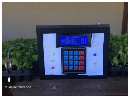
Figura 10 - Protótipo executando as leituras em ambiente de produção
