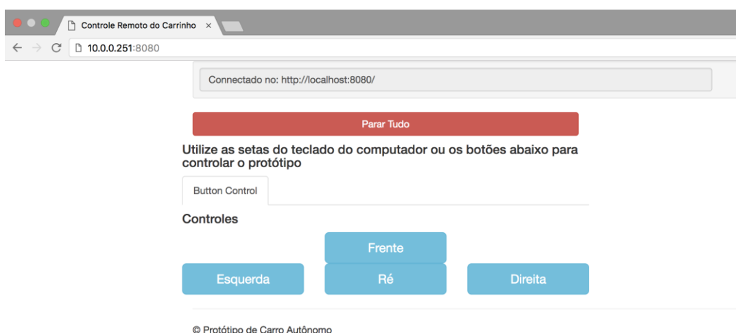
Figura 22 - Página HTML da aplicação no Raspberry PI para o controle do RASPCAR
