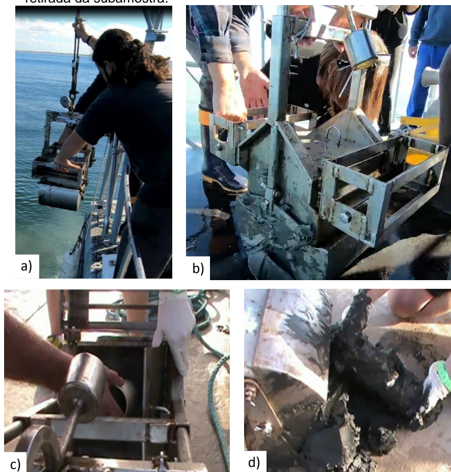
Figura 1 – Procedimento de amostragem utilizando amostrador Box Corer. a) Box Corer sendo içado pelo guindaste na posição da amostragem. b) Amostrador após a coleta do solo. c) Compartimento superior aberto para a retirada da subamostra através da cravação de um tubo de PVC . d) Abertura do compartimento inferior para a retirada da subamostra.
