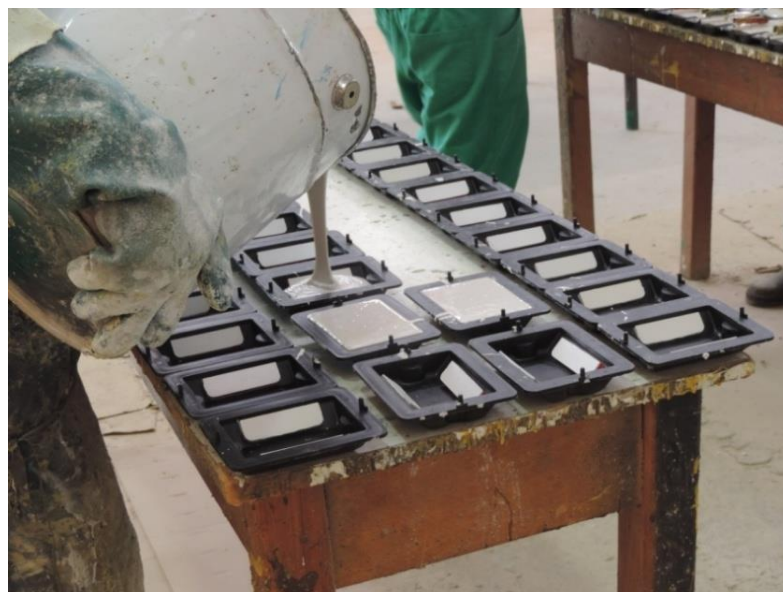
Figura 4 – Preenchimento das formas
