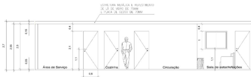
Figura 4- Corte BB Arquitetônico
