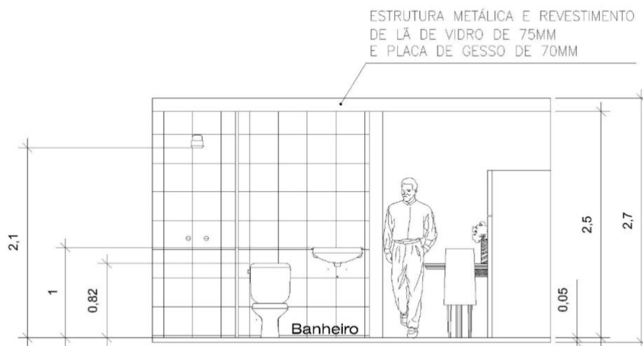
Figura 3- Corte AA Arquitetônico
