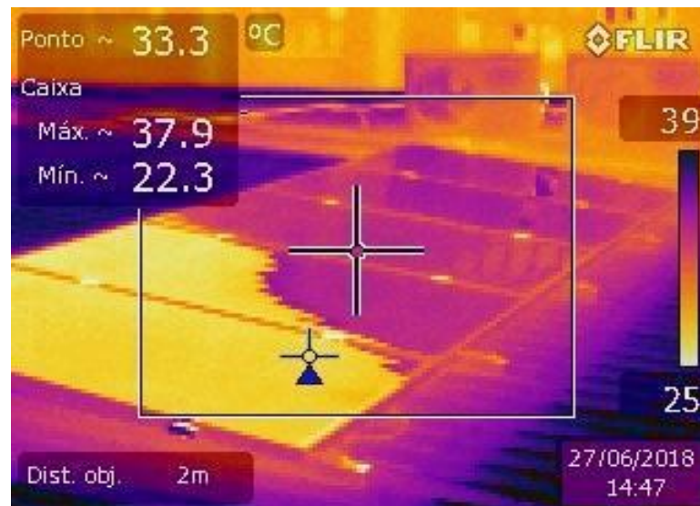
Figura 10 - Temperatura dos módulos de acordo com a termografia
