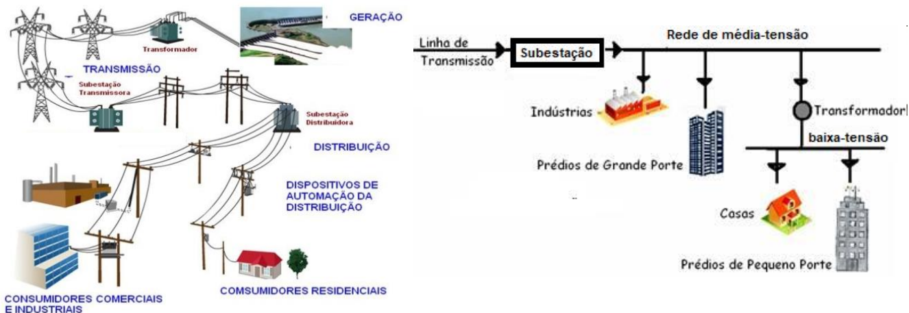
Figura 1 – Aspecto simplificado da geração, transmissão e distribuição e energia elétrica – rede aérea
