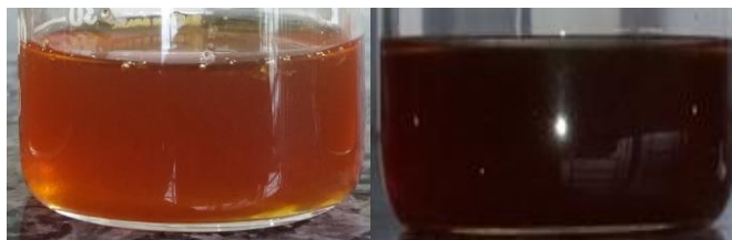
Figura 3. Resultados para a reações de Lugol: (A) mel puro; (B) mel com resultado positivo.
