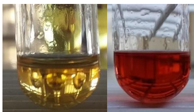
Figura 2. Resultados para a reações de Fiehe: (A) mel puro; (B) mel com resultado positivo.
