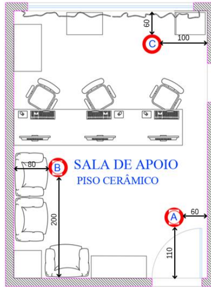
Figura 9 – Localização dos pontos de medição.
