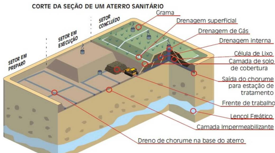
Figura 1 - Corte da seção de um aterro sanitário.
