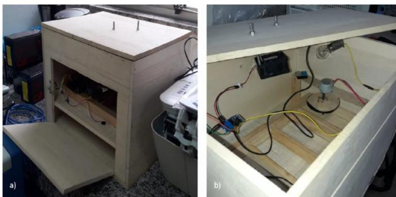
Figura 5 – a) Estrutura externa da chocadeira b) Estrutura interna.
