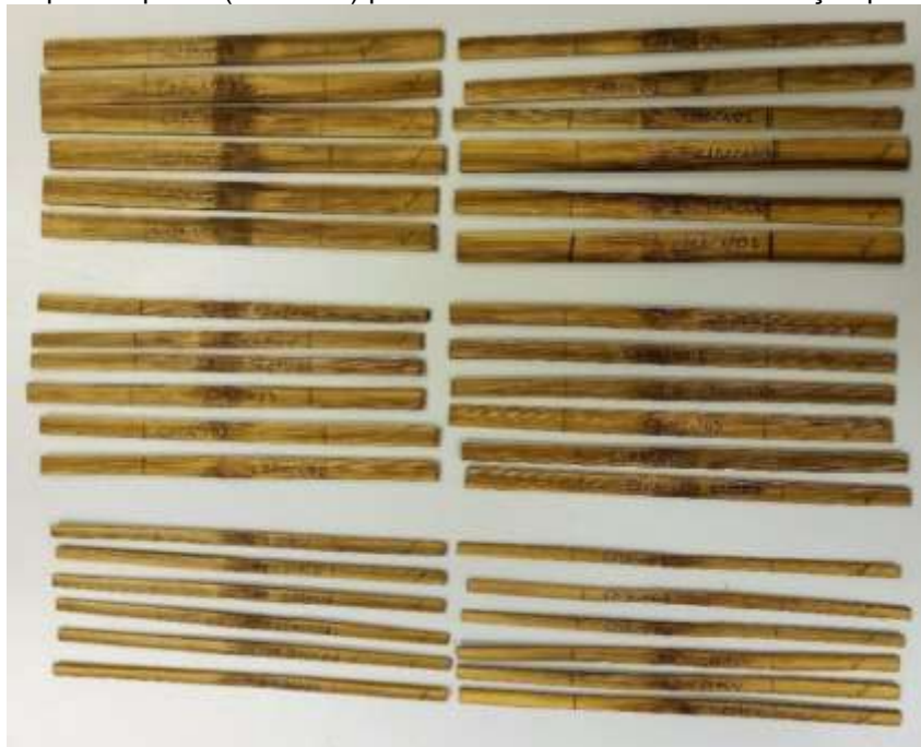
Figura 7 – Corpos de prova (com óleo) para o ensaio de Resistência à tração paralela às fibras
