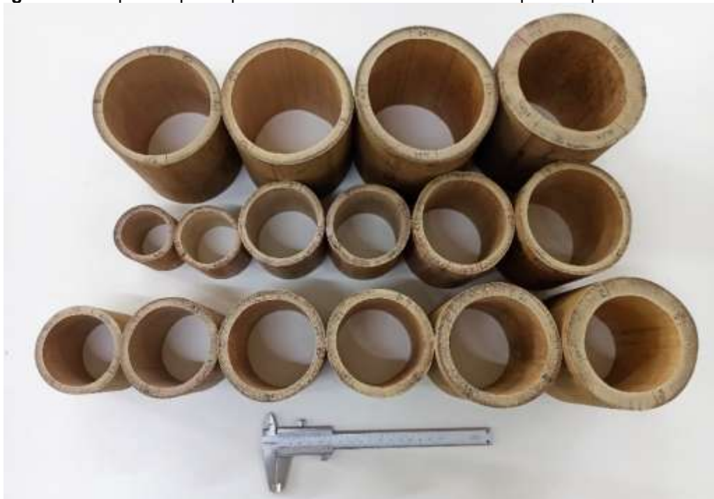
Figura 4 – Corpos de prova para o ensaio de resistência à compressão paralela às fibras
