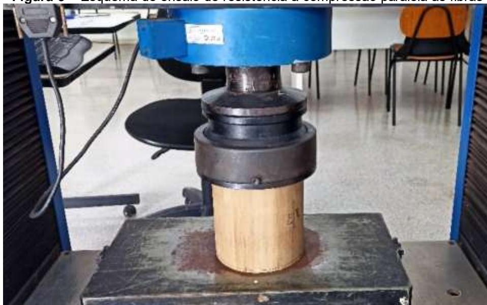
Figura 5 – Esquema de ensaio de resistência à compressão paralela às fibras
