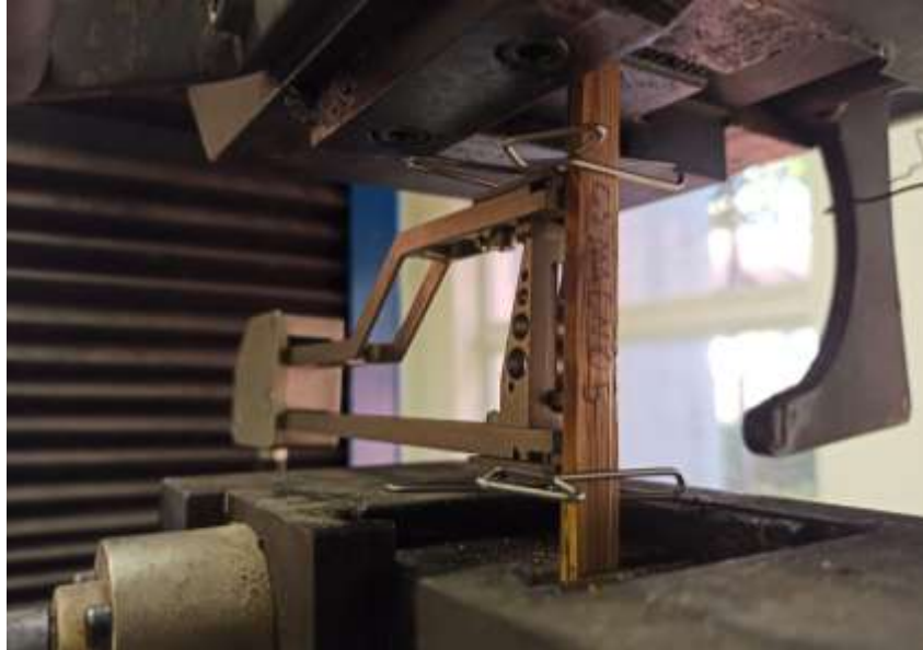
Figura 8 – Esquema do ensaio de resistência à tração paralela às fibras
