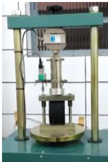
Figura 4 – Prensa para aplicação de carga do ensaio de resistência à tração.
