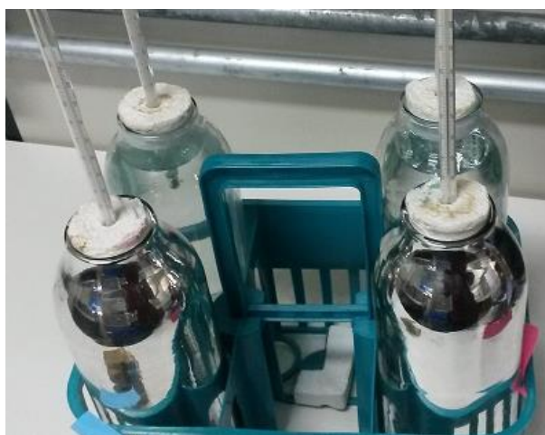
Figura 3 – Sistema de medição das temperaturas nas ampolas
