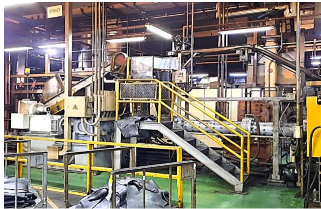
Figura 6 – Extrusora de fabricação de pneus com o sistema de controle em lógica nebulosa.
