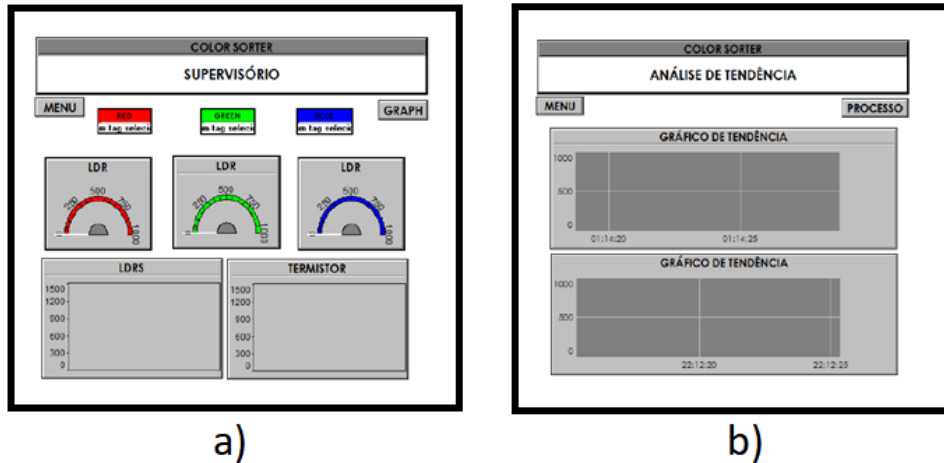
Figura 15 a) Tela de supervisão de processos. b) Tela para análise de tendência.
