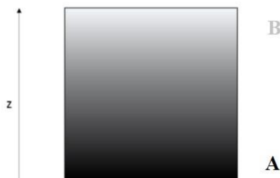
Figura 1 – Ilustração esquemática de um compósito do tipo FGM.
