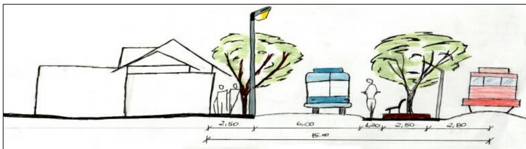
Figura 5: esquema montado no programa de extensão para a proposta de urbanização da comunidade, que mostra o afastamento de 15,00m das casas em relação à linha férrea.
